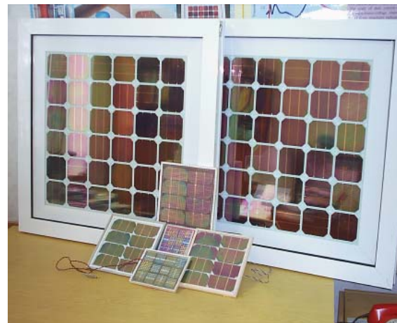
a) b) Fig. 3. Celule (a) și panouri (b) solare în baza structurilor ITO-nSi
